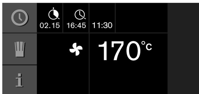
L'apparecchio va in pausa. Sul display appaiono la modalità di funzionamento, la temperatura, il tempo di cottura e la fine del tempo di cottura. L'apparecchio si avvia all'ora calcolata e si spegne automaticamente quando il tempo di cottura è terminato.
