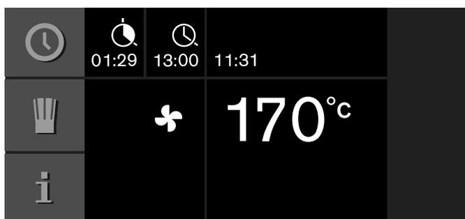
Un minuto prima della fine del tempo di cottura viene visualizzato ingrandito il tempo che decorre sul display.
