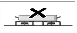
No caliente nunca un recipiente de cocción (p.ej. asador, sartén, piedra para grill) con varios quemadores. La acumulación de calor produce daños en el aparato.
