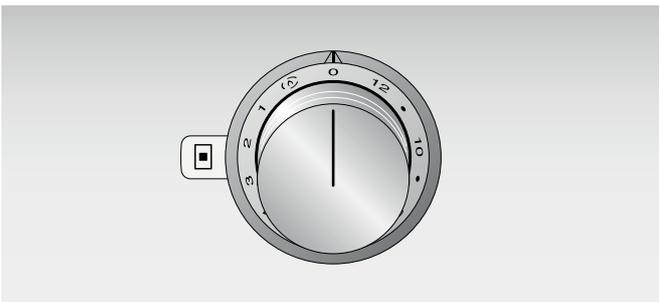
Las marcas en la maneta de mando muestra el ajuste del nivel de cocción 1 hasta 12 o bien el nivel de fuego lento (🔥).
