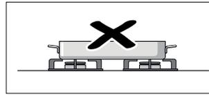
Μη θερμαίνετε ποτέ ένα μαγειρικό σκεύος (π.χ. ψηλή φόρμα, βαθύ ταψί, πέτρα ψησίματος γκριλ) με περισσότερους καυστήρες. Η προκύπτουσα συσσώρευση θερμότητας οδηγεί σε βλάβη στη συσκευή.
