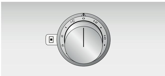
As marcações no botão de comando indicam o ajuste do nível de potência 1 até ao 12 ou o nível de fervura lenta (☹).
