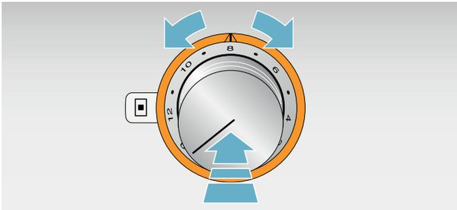
Se puede ajustar el nivel de potencia deseado girando el mando de control.
