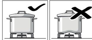
Μη χρησιμοποιείτε ένα παραμορφωμένο μαγειρικό σκεύος, το οποίο δε στέκεται σταθερά πάνω στη βάση εστιών. Τα σκεύη μπορούν να ανατραπούν.
