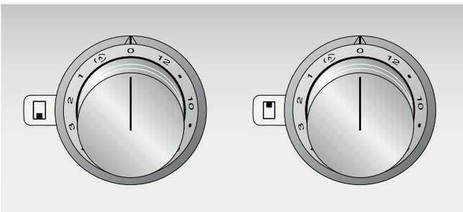
Las marcas en la maneta de mando muestra la asignación a los quemadores respectivos y el ajuste del nivel de cocción 1 hasta 12 o bien nivel de fuego lento (☀).
