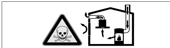
Ildsteder, hvis lufttilførsel sker fra indeluften, (f.eks. gas-, olie-, træ- eller kulfyrede varmeapparater, gennemstrømningsvandvarmere, vandvarmere) henter deres forbrændingsluft fra opstillingsrummet og fører røggassen ud gennem en røggaskanal(f.eks. skorsten) til det fri.
