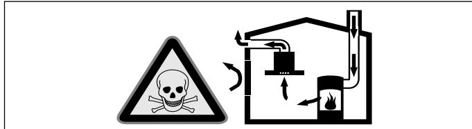
Huoneilmaa tarvitsevat tulisijat (esim. kaasu-, öljy-, puu- tai hiilikäyttöiset lämmityslaitteet, läpivirtauskuumennin, vedenkuumennin) ottavat polttoilman huonetilasta ja johtavat poistoilman poistoilmalaitteen (esim. savutorven) kautta ulos.
