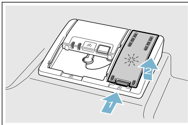
2. Llenar el abrillantador cuidadosamente hasta alcanzar la marca de máximo llenado del depósito.
