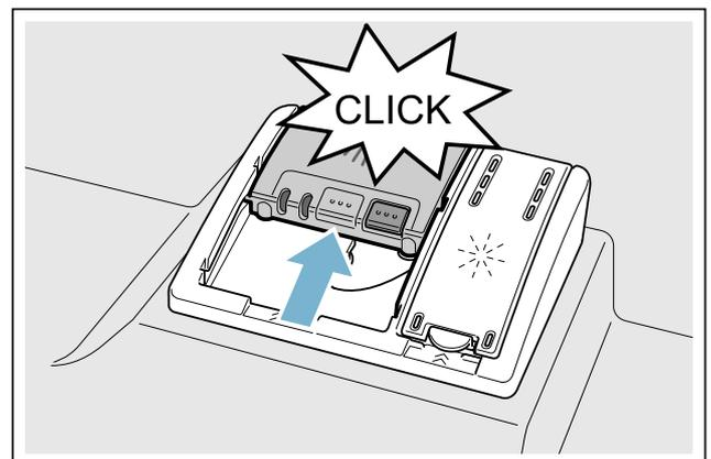
La cámara del detergente se abre automáticamente y en el instante adecuado, según el programa de lavado seleccionado. Los detergentes en polvo o líquido se reparten por todo el interior de la cuba del aparato, disolviéndose. Las pastillas de detergente, por su parte, son recogidas en la bandeja correspondiente, donde se disuelven de un modo dosificado.
