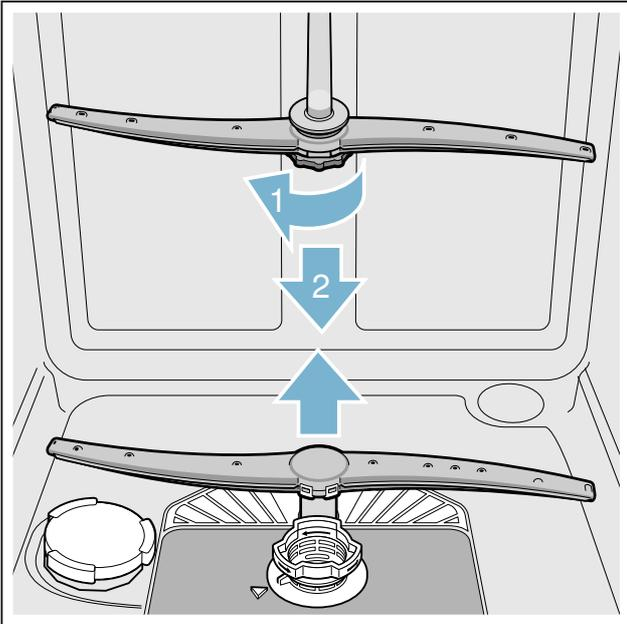
4. Sprüharme unter fließendem Wasser reinigen.
