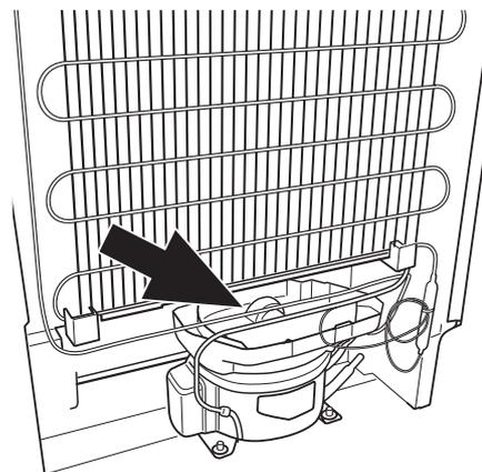
Pour éviter dans ce cas que le bac d'évaporation ne déborde, récupérez cette eau à l'aide d'une éponge. L'évaporateur est entièrement dégivré lorsqu'il ne coule plus d'eau de dégivrage dans le bac d'évaporation. Nettoyez le compartiment intérieur. Remettez ensuite l'appareil en service.
