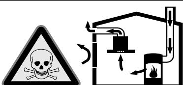
依靠室内空气工作的生热设备（例如使用燃气、燃油、木头或煤炭的加热器、连续流加热器或热水器）消耗所在安装室内的空气，并通过排气系统（例如烟囱）将废气排放到室外。
