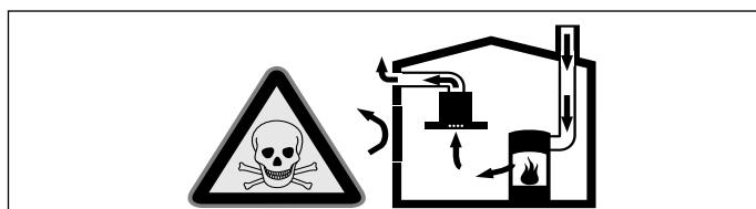
依靠室内空气工作的生热设备（例如使用燃气、燃油、木头或煤炭的加热器、连续流加热器或热水器）消耗所在安装室内的空气，并通过排气系统（例如烟囱）将废气排放到室外。
