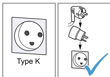
Fagligt ukorrekt tilslutning af apparater over 13 A/3 kW er farlig. Angivelserne om dette apparats effekt findes på typeskiltet
