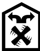
Всасываемый воздух проходит через жироулавливающие фильтры и фильтр с активированным углём и очищенным выводится обратно в кухню.
