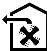
Zassane powietrze jest czyszczone przez filtr przeciwłuszczywy i kierowane na zewnątrz poprzez system rur.
