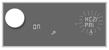
Das Gerät versucht automatisch, sich mit der App zu verbinden. Im Einstellbereich blinken abwechselnd H[2] und PR 1. In der Kochstellenanzeige blinkt der Wert  $\square \square$ .
