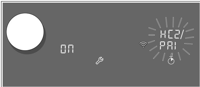
Laite yrittää muodostaa automaattisesti yhteyden sovellukseen. Säätöalueella vilkkuvat vuorotellen **HC2** ja **PR 1**. Keittoalueen näytössä vilkkuu arvo **ON**.
