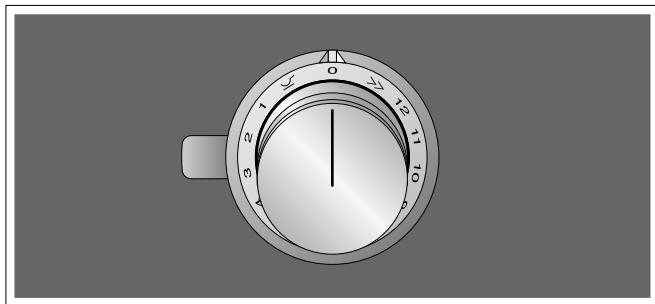
Kumanda düğmesi ile pişirme kademesini, PowerBoost fonksiyonunu ve Wok fonksiyonunu seçebilirsiniz.
