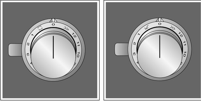
您可以使用控制旋钮选择加热设置、火力推进功能 (PowerBoost)、灵活烹饪区 (FlexZone) 以及炒锅功能。
