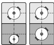
前后电磁灶头各有两个感应器，可独立使用。为每个电磁灶头选择所需的加热设置。每个电磁灶头上只能使用一个烹饪容器。
