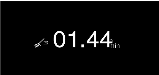
**Nota:** Aparece un mensaje en el panel indicador después de aprox. 1 hora y 30 minutos. Retirar y vaciar el depósito. Limpiar a fondo el depósito. Cargar agua limpia en el depósito. Introducir el depósito en el aparato. Confirmar con . Iniciar el proceso de aclarado con .
