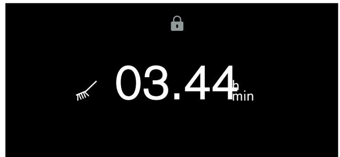
Cuando el programa de limpieza se termina, suena una señal. La puerta del aparato se desbloquea. Aparece un mensaje en el panel indicador.
