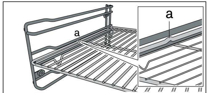
Al introducir la bandeja con orificios, asegurarse de que la lengüeta de enganche (a) señale hacia arriba.
