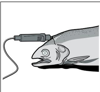
**Dar la vuelta al alimento:** para dar la vuelta al alimento, no extraer la termosonda. Tras dar la vuelta al alimento, comprobar que la termosonda de carne siga en su posición correcta.
