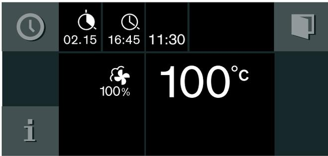
O aparelho entra em posição de espera. No indicador aparece o modo de funcionamento, a temperatura, o tempo de cozedura e o final do tempo de cozedura. O aparelho é iniciado à hora calculada e desliga-se automaticamente, depois de decorrido o tempo de cozedura.
