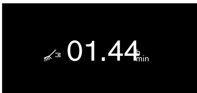
**Указание:** Примерно через 1 час 30 мин на дисплее появляется сообщение. Извлеките и опорожните резервуар для воды. Тщательно очистите резервуар. Заполните резервуар свежей водой. Установите резервуар внутрь прибора. Подтвердите нажатием . Начните процесс промывки с .
