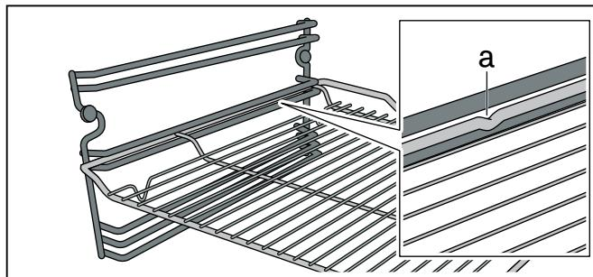
При установке лотка с отверстиями следите за тем, чтобы фиксирующий выступ (а) находится сзади и был направлен вниз.
