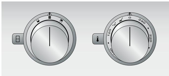
Con el mando de control derecho, seleccionar la temperatura entre 120-240 °C, la posición de conservación en caliente o el nivel de limpieza .
