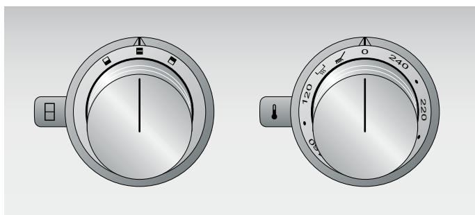
Com o comando do lado direito, selecione a temperatura entre 120 - 240 °C, o nível para manter quente ou o nível de limpeza .
