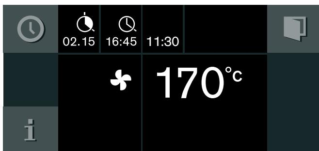
Прибор переходит в состояние ожидания. На дисплее отображается режим работы, температура, время приготовления и время окончания. Прибор запускается в рассчитанное время и выключается по истечении времени приготовления.
