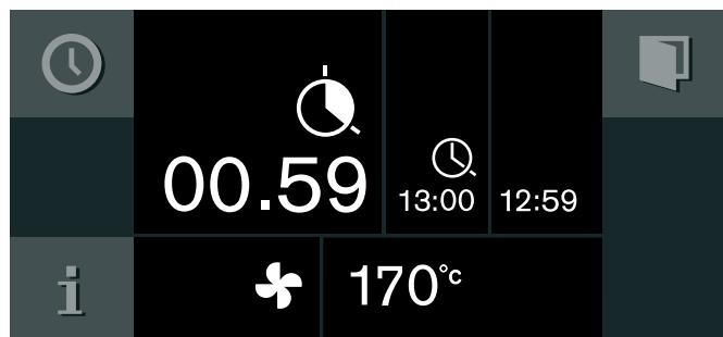
После окончания времени приготовления прибор выключается. Мигает символ ○ и выдается звуковой сигнал. Он прекращается, как только Вы прикоснетесь к символу ✓, откроете дверь прибора или установите переключатель функций на 0.
