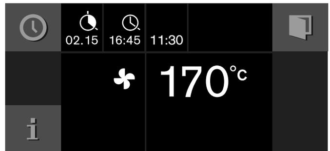
L'appareil est en position d'attente. Sur l'afficheur, le mode, la température, le temps de cuisson et la fin de cuisson sont visibles. L'appareil démarre à l'heure calculée et s'arrête automatiquement lorsque le temps de cuisson s'est écoulé.
