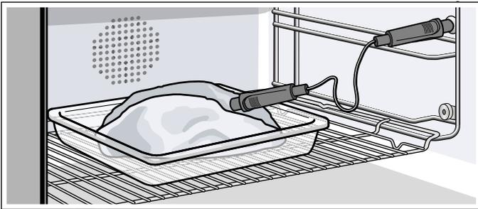
**Pollame:** infilzare fino alla fine la termosonda nella parte più spessa del petto di pollo. A seconda delle caratteristiche del pollame infilzare la termosonda trasversalmente o nel senso della lunghezza. Per il pollame verificare che la punta della termosonda non si infili nella cavità centrale.
