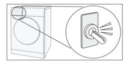
L'eau de condensation est pompée dans le réservoir d'eau de condensation par une pompe. Des bruits de pompage se font donc entendre
