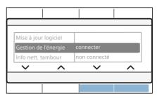
Votre appareil tente désormais de se connecter au Smart Energy System (gestionnaire d'énergie). Si l'appareil s'est correctement connecté, l'affichage indique : connecter ...
