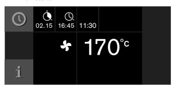
Das Gerät geht in Warteposition. In der Anzeige erscheinen die Betriebsart, die Temperatur, die Garzeit und das Garzeit-Ende. Das Gerät startet zum errechneten Zeitpunkt und schaltet automatisch aus, wenn die Garzeit abgelaufen ist.
