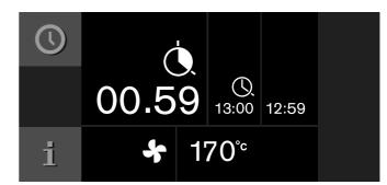
Nach Ablauf der Garzeit schaltet das Gerät aus. Das Symbol ♠ pulsiert und es ertönt ein Signal. Es verstummt vorzeitig, wenn Sie das Symbol ✔ berühren, die Gerätetür öffnen oder den Funktionswähler auf 0 stellen.
