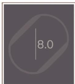
面板顯示已啟動電源的烹飪位置。您設定的火力等級會顯示於面板。
