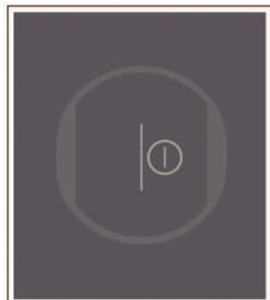
面板顯示已被偵測到的烹飪位置。欲選取烹飪位置，請觸碰 ① 符號。
