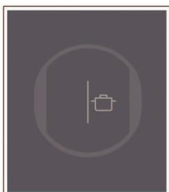
若此符號出現在該烹飪位置的顯示器上，表示無法完整移轉設定值。此時，請抬起鍋具、或移動其在爐面上的位置。再次針對該烹飪位置進行設定。
