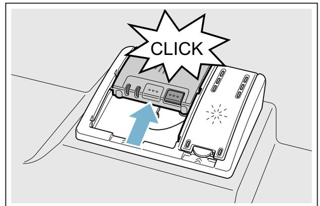
Die Reinigerkammer öffnet sich programmabhängig automatisch zum optimalen Zeitpunkt. Der Pulver- oder Flüssigreiniger verteilt sich im Gerät und wird aufgelöst, der Tab fällt in die Tab-Auffangschale und löst sich dort dosiert auf.
