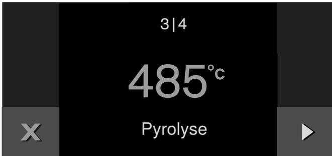
Nach Ablauf der Pyrolyse ertönt ein Signal. Eine Meldung erscheint im Display. Wenn das Gerät abgekühlt ist, die zurückgebliebene Asche mit einem feuchten Tuch aus dem Garraum wischen.
