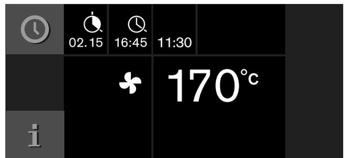
Das Gerät geht in Warteposition. In der Anzeige erscheinen die Betriebsart, die Temperatur, die Garzeit und das Garzeit-Ende. Das Gerät startet zum errechneten Zeitpunkt und schaltet automatisch aus, wenn die Garzeit abgelaufen ist.
