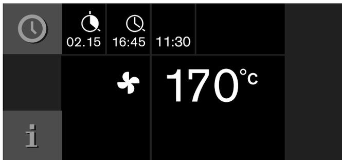
L'apparecchio passa in modalità stand-by. Sull'indicatore compaiono la modalità di funzionamento, la temperatura, il tempo di cottura e la fine tempo di cottura. L'apparecchio si avvia al momento giusto e si arresta automaticamente quando è trascorso il tempo di cottura impostato.
