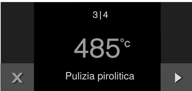
Una volta trascorsa la pulizia pirolitica viene emesso un segnale acustico. Sul display compare un messaggio. Quando l'apparecchio si è raffreddato, eliminare la cenere residua con un panno umido dal vano cottura.
