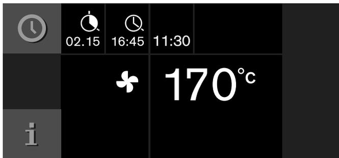
O aparelho entra em modo de espera. O visor indica o modo de funcionamento, a temperatura, o tempo de cozedura e o fim do tempo de cozedura. O aparelho inicia no momento calculado e desliga-se automaticamente depois de o tempo de cozedura terminar.
