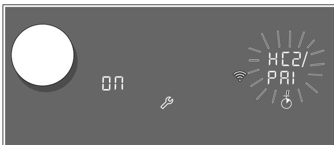
L'apparecchio prova automaticamente a connettersi all'app. Nel campo di regolazione lampeggiano in modo alternato *HC2* e *PA1*. Sull'indicatore delle zone di cottura lampeggia il valore *ON*.
