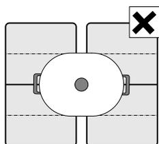
Per piani di cottura con più di un'area di cottura flessibile, accertarsi che la stoviglia sia posizionata in modo tale da coprire soltanto una delle aree di cottura flessibili.
