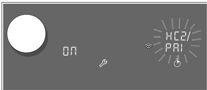
L'apparecchio prova automaticamente a connettersi all'app. Nel campo di regolazione lampeggiano in modo alternato *HC2* e *PRI 1*. Sull'indicatore delle zone di cottura lampeggia il valore *ON*.
