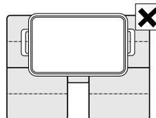
La stoviglia non può coprire contemporaneamente le due aree di cottura laterali e l'area di cottura FlexPlus.
