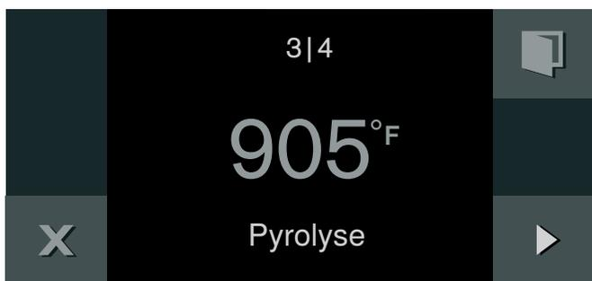
Un signal sonore retentit une fois la pyrolyse terminée. Un message apparaît. Lorsque l'appareil a refroidi, essayez les cendres restantes dans le compartiment de cuisson à l'aide d'un linge humide.
