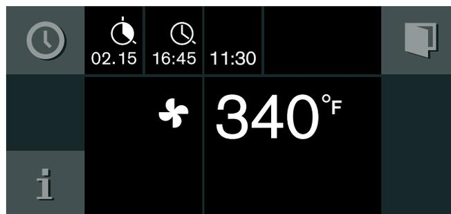
L'appareil se met en mode veille. Le mode, la température, le temps et la fin de cuisson s'affichent. L'appareil démarre à l'heure calculée et s'arrête automatiquement lorsque le temps de cuisson est terminé.
