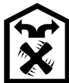
L'air aspiré est nettoyé en traversant les filtres à graisse et à charbon actif, puis il revient dans la cuisine.
