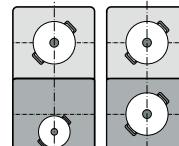
前後加熱區各有兩個獨立感測器可獨立運作。您可分別選擇各加熱區所需的加熱值。每個加熱區上僅可使用一個鍋具。
