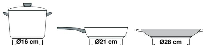
Se l'area di cottura flessibile viene utilizzata come unica zona di cottura, è possibile utilizzare recipienti più grandi, particolarmente adatti per questa zona. Leggere qui → "Funzione flex" ulteriori informazioni sul posizionamento delle stoviglie
