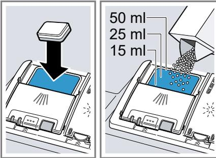
Wenn Sie Tabs verwenden, genügt eine Tablette. Tabs quer einlegen. Wenn Sie Pulverreiniger oder Flüssigreiniger verwenden, beachten Sie die Dosierungshinweise des Herstellers und die Dosierungseinteilung der Reinigerkammer. Bei normaler Verschmutzung genügen 20 ml – 25 ml Reiniger. Bei wenig verschmutztem Geschirr genügt eine etwas geringere als die angegebene Reinigermenge.
