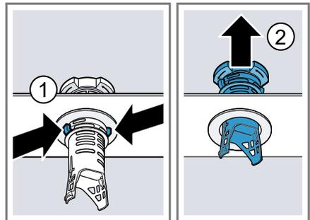
5. Unter fließendem Wasser die Siebelemente reinigen.
