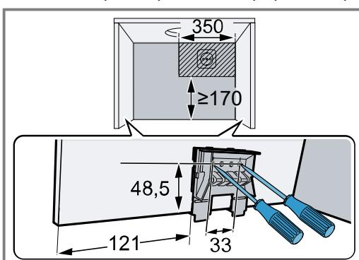
8. Толщина стенок 19 мм: откиньте распорки на обеих крепежных деталях.
