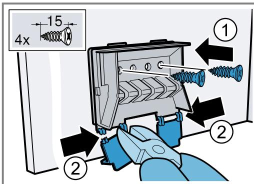
10. Снимите распорки снизу с крепежных деталей.
