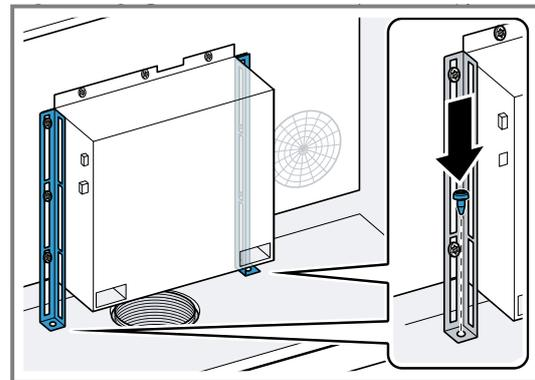
12. **Nota:** Se l'apparecchio della misura di 90 cm viene montato in un mobile della larghezza di 90 cm, saltare le due successive fasi di montaggio e osservare le istruzioni nella confezione fornita in allegato supplementare.
