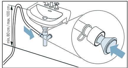
Anschluss-Stelle muss mit Schlauchschelle gesichert werden (Spannbereich 12-22 mm, Fachhandel). Bei Anschluss an einen Siphon ist zu beachten, dass der Ablaufschlauch über eine Höhe von min. 80 cm, jedoch max. 100 cm geführt wird.
