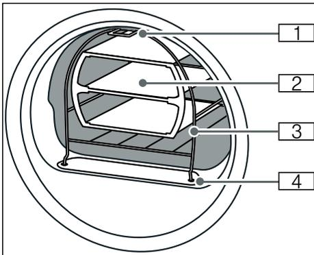
**1** Fuß zur Befestigung am Haken im oberen Teil der Vorderwand des Geräts
