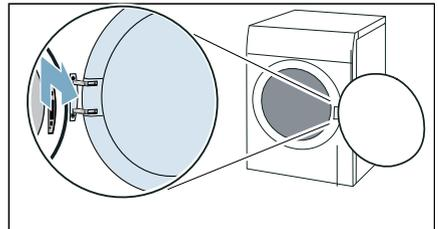
**Hinweis:** Achten Sie darauf, die Tür nicht zu beschädigen oder zu zerkratzen, indem Sie z. B. ein weiches Handtuch unterlegen.
