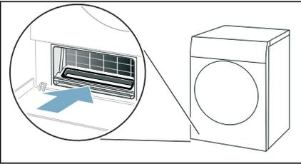
**11** Wärmetauscher-Abdeckung am Griff einschieben.
