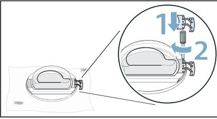
**Hinweis:** Achten Sie darauf, die Dichtung der Tür beim Einsetzen des Gelenks nicht einzuklemmen oder zu beschädigen.
