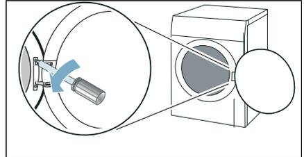
**Hinweis:** Verwenden Sie ausschließlich einen T20 (Torx) Schraubendreher und keine anderen Werkzeuge, um den Türanschlag zu wechseln.
