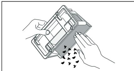
**Remarque :** Veillez à ce qu'aucun encrassement ne subsiste sur les joints du couvercle de l'échangeur thermique.
