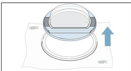
8 Ruotare di 180° il telaio dell'oblò e inserire correttamente l'oblò.
