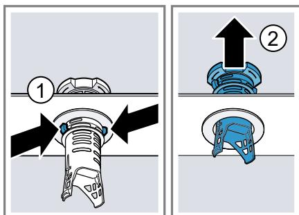
5. Промойте фильтрующие элементы проточной водой.
