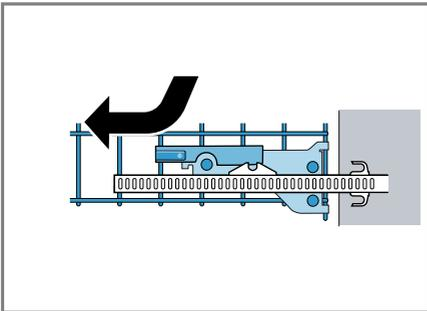
4. Poussez les rails de guidage dans l'appareil.
