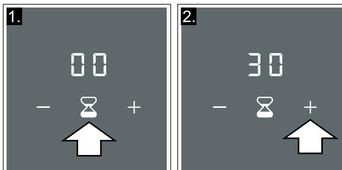
**Avvertenza:** Se si tiene premuto il simbolo **–** o **+**, il tempo di cottura si impone più velocemente.
