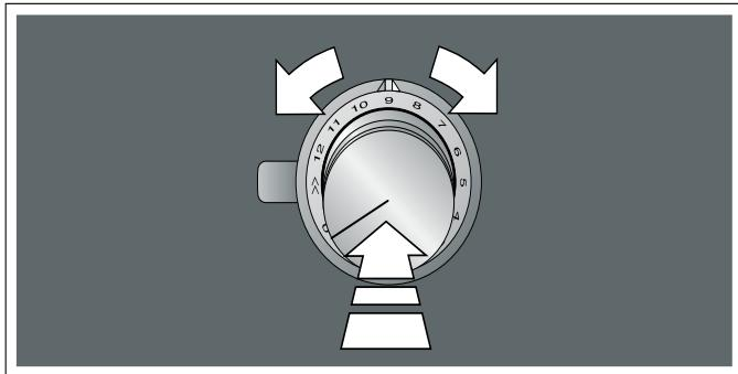
所选的加热设置将在灶头显示屏上亮起。控制旋钮周围的光圈将亮起。
