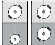
前后电磁灶头每个都有两个感应器，可独立使用。选择每个电磁灶头所需要的加热设置。每个电磁灶头上仅使用一个烹饪容器。
