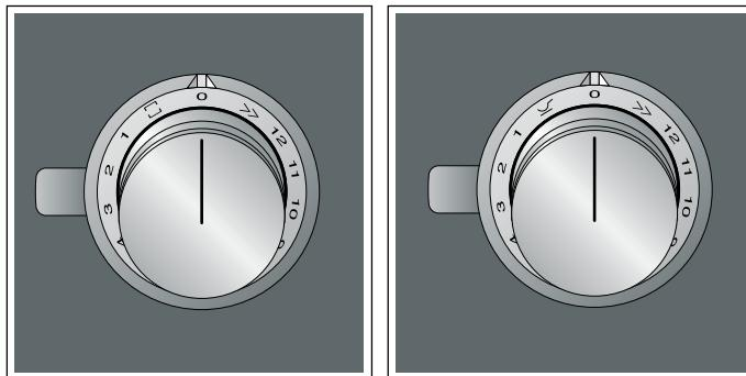
您可以使用控制旋钮选择加热设置、火力推进功能、灵活烹饪区以及炒锅功能。
