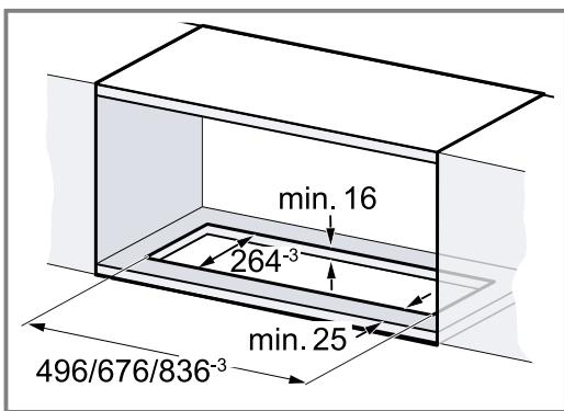
2. Crie o recorte para o tubo de extração acima do móvel embutido ou atrás do móvel embutido.
