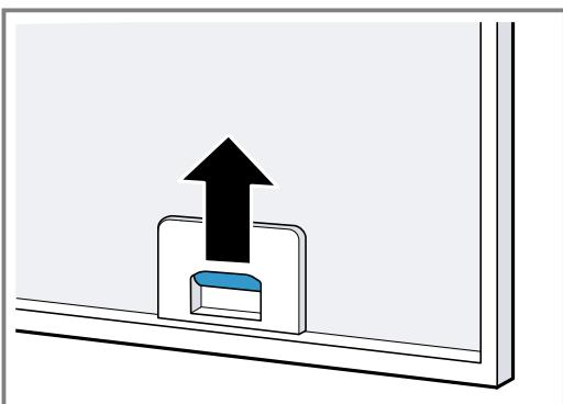
3. Retirar los filtros antigrasa de las sujetaciones. Sujetar los filtros antigrasa en posición horizontal para evitar que la grasa gotee.
