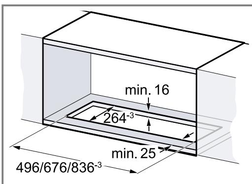
2. Realizzare un'apertura per il tubo di scarico o sopra oppure dietro il mobile da incasso.
