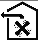
L'aria non deve essere deviata in un cammino che viene utilizzato per lo scarico di gas di apparecchi che bruciano gas o altri combustibili (questo non vale per apparecchi a ricircolo d'aria).
