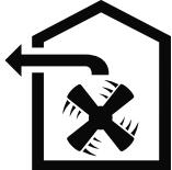
Ο αέρας δεν επιτρέπεται να διοχετεύεται σε μια καμινάδα, η οποία χρησιμοποιείται για τα καυσαέρια συσκευών, που λειτουργούν με αέριο ή άλλα καύσιμα (αυτό δεν ισχύει για συσκευές ανακυκλοφορίας αέρα).
