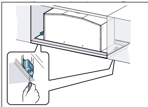
3. Τοποθετήστε το πλαίσιο και βιδώστε το από κάτω με τη συσκευή.
