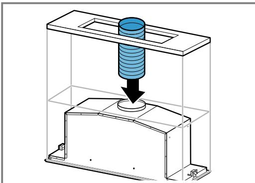
2. Κατασκευάστε τη σύνδεση προς το άνοιγμα εξαερισμού.
