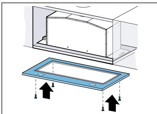
4. Ασφαλιστε το πλαίσιο και τη συσκευή με βίδες.
