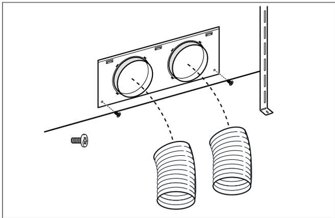
**Nota:** Si se utiliza un tubo flexible de aluminio, pulir previamente la zona de conexión.
