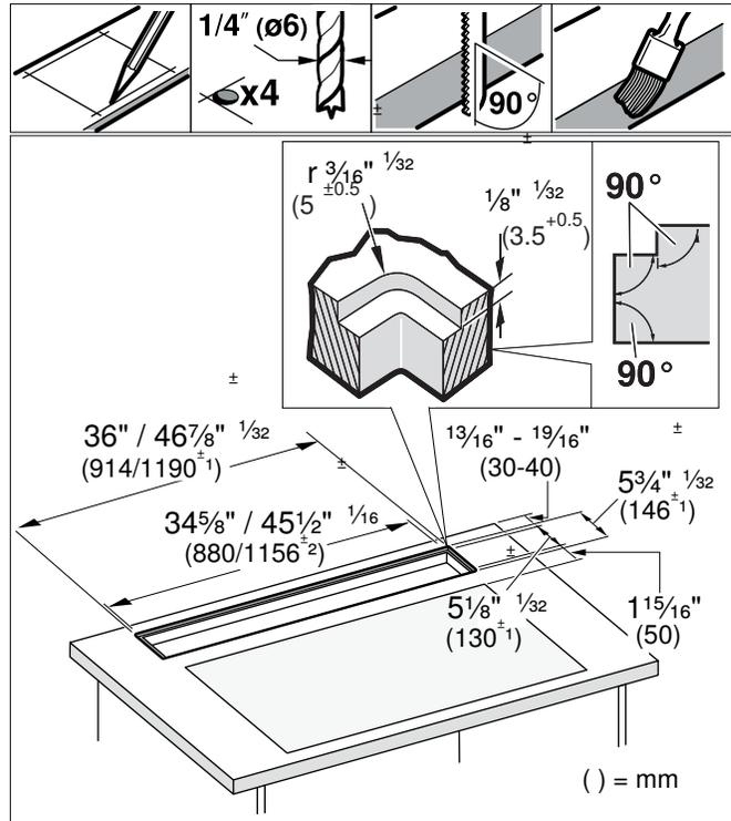
**Montaje a ras de superficie:** El aparato se puede montar en las siguientes encimeras resistentes a la temperatura y al agua:
