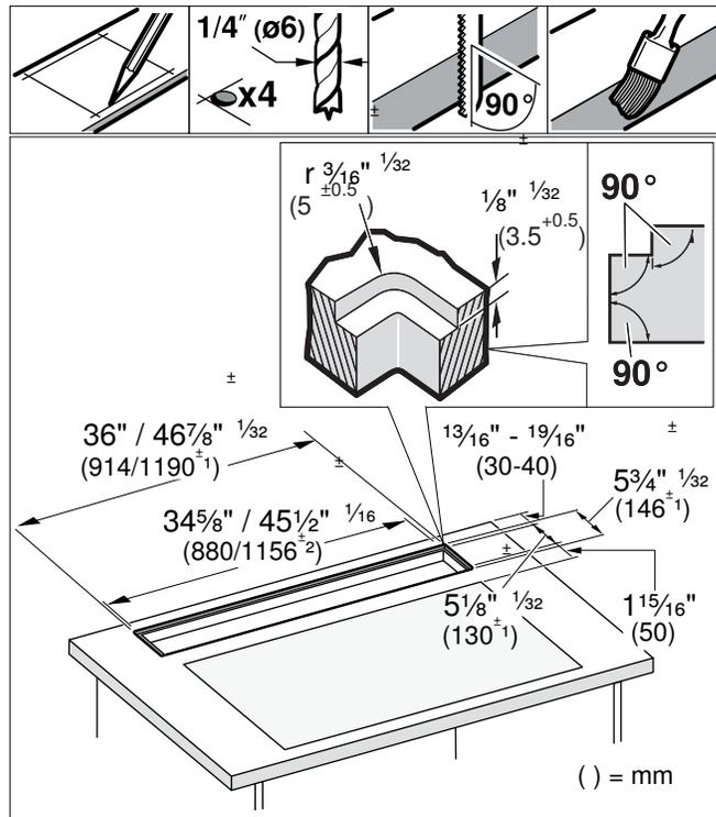
**Pose en affleurement:** L'appareil peut être encastré dans des plans de travail résistant à la chaleur et à l'eau, fabriqués dans les matériaux suivants :
