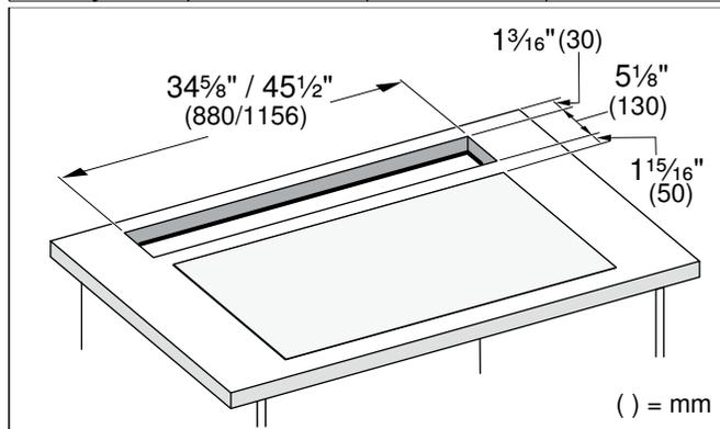
**Pose en affleurement:** L'appareil peut être posé en affleurement dans un plan de travail.
