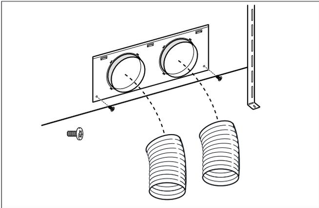
**Remarque :** En cas d'utilisation d'un tuyau en aluminium, lisser au préalable la zone de raccordement.
