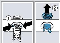
5. Limpiar los elementos filtrantes bajo el chorro de agua del grifo.
