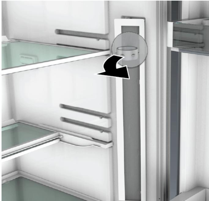
3. Odpojte elektrické pripojenie bočného pásového LED svetla.
