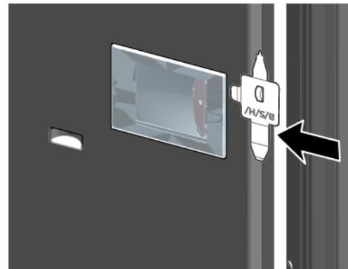
2. Pokrovček točkovne lučke LED povlecite navznoter in ga hkrati potisnite naprej.
