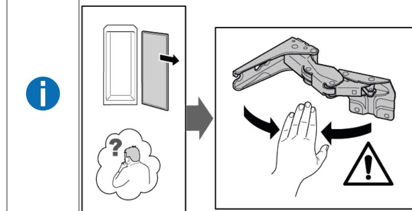
1. Demontați capacele a două balamale.
