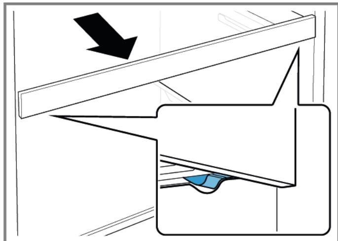
2. Uzatılabilir raf yüzeyini aşağı indirin ve yana doğru döndürerek çıkartın.
