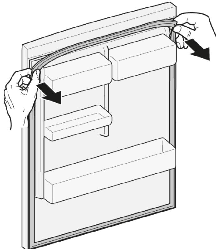
2. Demontați garnitura ușii din canelură.
