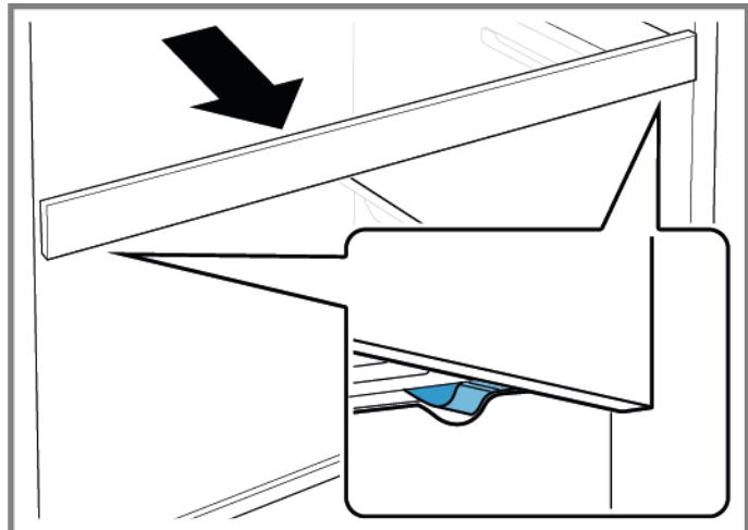
2. Laat het uittrekbare plateau zakken en draai het naar de zijkant eruit.
