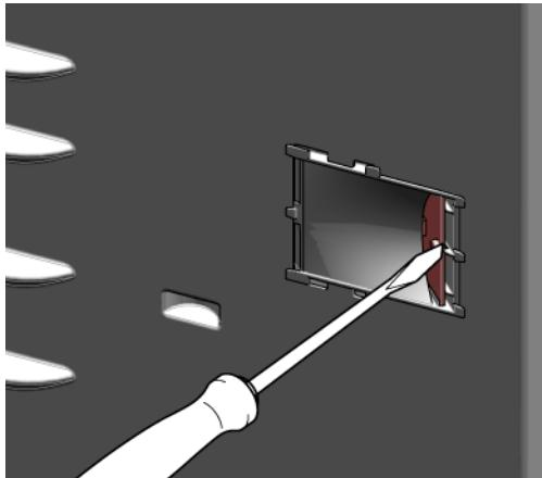
4. Den elektrischen Anschluss des LED-Strahlers trennen.
