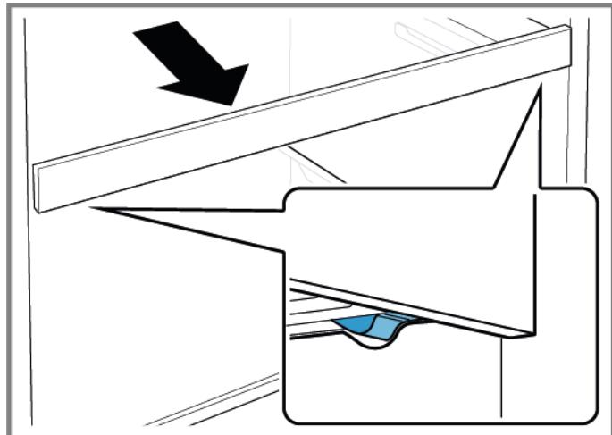
2. Spustite izvlačnu policu i zaokrenite je bočno.
