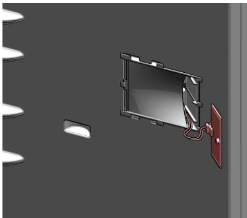
➔ Der LED-Strahler ist entfernt.
