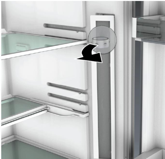
3. LED yan çubuk ışığının elektrik bağlantısını ayırin.
