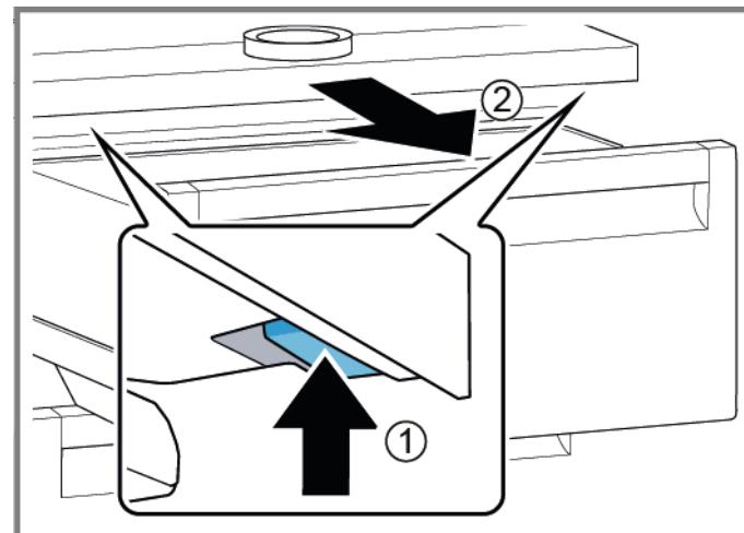
4. Podnieść przegródkę i obracając wyjąć ją z boku.
