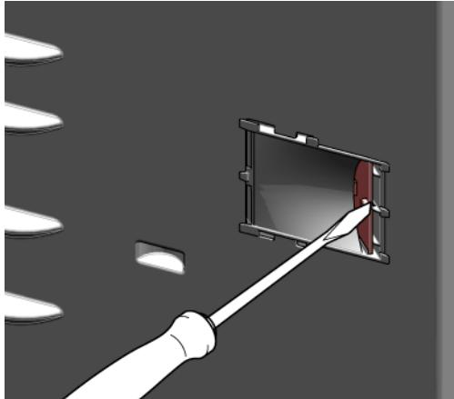
4. Odpojte elektrické pripojenie bodového LED svetla.
