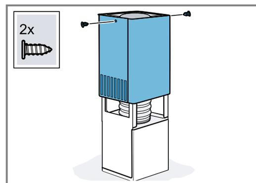
5. Установите обе части нижней обшивки вытяжной трубы на прибор и зафиксируйте.
