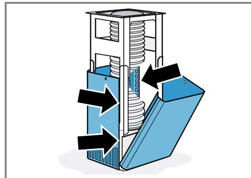
**Заметка:** Прорези секции обшивки вытяжной трубы должны быть направлены вниз.
