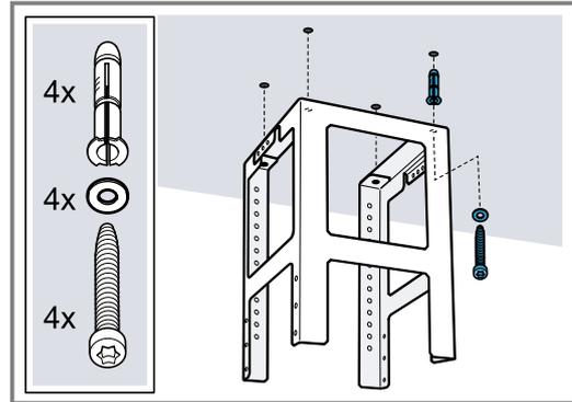
4. Просверлите четыре отверстия под крепления диаметром 8 мм и глубиной 80 мм и забейте дюбели заподлицо со стеной.
