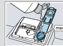
3. Cerrar la tapa del depósito del abrillantador. ✓ La tapa encaja de modo audible.
