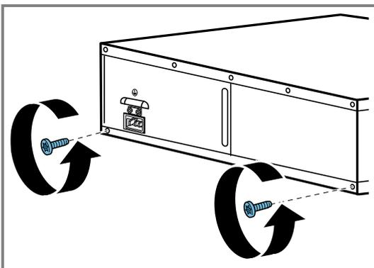
6. Aparafuse os dois suportes metálicos no lado de trás do aparelho com os dois parafusos.
